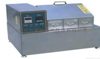
蒸汽老化实验机
